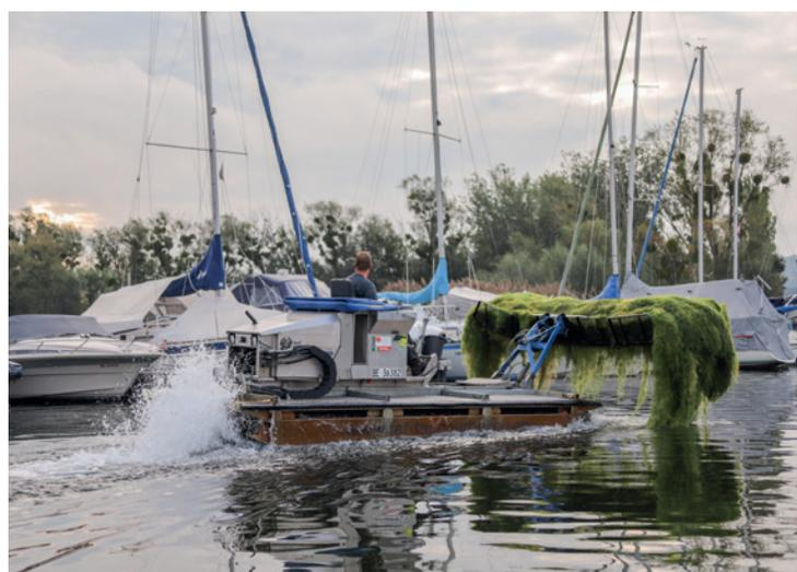
**N**otre Amphimaster est un bateau amphibie d'entretien des eaux unique au monde. C'est une véritable machine multifonctionnelle sur terre comme sur mer. Là où les machines classiques ne peuvent pas aller, il accomplit un travail complet par exemple sur les rives des zones marécageuses. Grâce à sa chenille, l'Amphimaster glisse sur les sols sensibles, par exemple sur les terrains de golf ou dans les réserves naturelles, sans les endommager.
