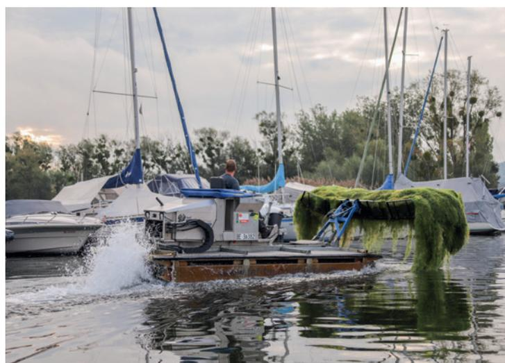
**U**nser Amphimaster ist ein weltweit einzigartiges amphibisches Gewässerpflegeboot und eine wahre Multifunktionsmaschine an Land sowie zu Wasser. Wo klassische Maschinen nicht hingelangen, leistet er – beispielsweise an Ufern von Sumpfbereichen – volle Arbeit. Mittels Raupe gleitet der Amphimaster über empfindliche Böden, z. B. auf Golfplätzen oder in Naturreiservaten, ohne diese zu beschädigen.
