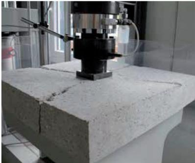
Spitzbeton Energieabsorption bei Faserverstärkten plattenförmigen Prüfkörpern.
