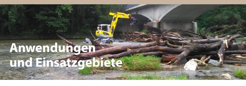
Menzi Muck steht für die Technologieführerschaft im Schreitbaggerbau. Das spezielle Baggerkonzept, das ohne Kontergewicht auskommt und damit bei leichtem Einsatzgewicht hohe Leistungen gewährleistet findet sich in allen gängigen Baggeranwendungsbereichen.
