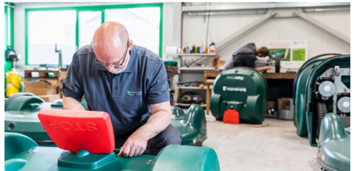
Prüf- und Programmierbereich für Belrobotics-Mähroboter
