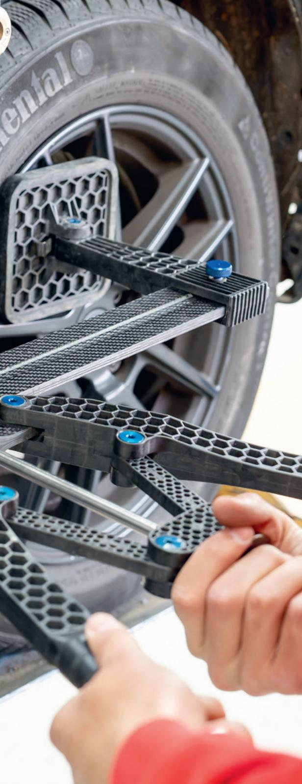
Als Spezialität wird das Ausbeulen ohne Lackieren angeboten. Bei Parkschäden oder Hagelunwettern kommt diese schonende Reparaturmethode zum Einsatz. Sie ermöglicht eine massive Kostenreduktion gegenüber Lackierarbeiten, ist schnell und verursacht keine umweltbelastenden Emissionen.
