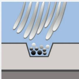
Schmutz und Bakterien dringen in offene Fugen und lassen sich durch Reinigen kaum entfernen.
